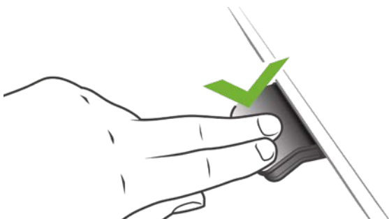
Abbildung 2: Drücken und halten Sie das DPG, um den Tisch nach unten zu fahren
